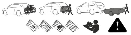
ВНИМАНИЕ: при использовании ТСУ для транспортировки багажной системы/багажник (велокрепление, мотохвост, автобокс, грузовая платформа) необходимо учитывать, что центр масс багажника смещен относительно оси шарового наконечника, что вызывает дополнительные нагрузки. Поэтому общая полная масса багажной системы (багажник + груз) не должна превышать значений, указанных в таблице;
